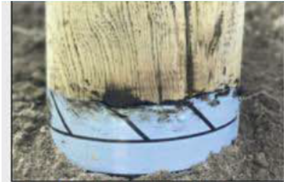
Spækkkerne; hvor vandet løber ind bag tjæren, er lette at se. (Importørens reklamebilleder er til fri afbenyttelse, når formålet er oplysning om produktet)
