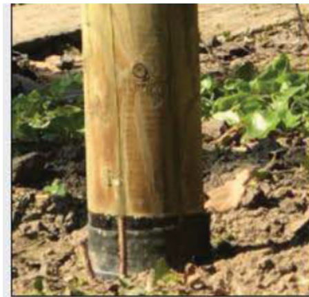
Her har sprækken i stolpen vist også sprængt plastikken. (Importørens reklamebilleder er til fri afbenyttelse, når formålet er oplysning om produktet)
